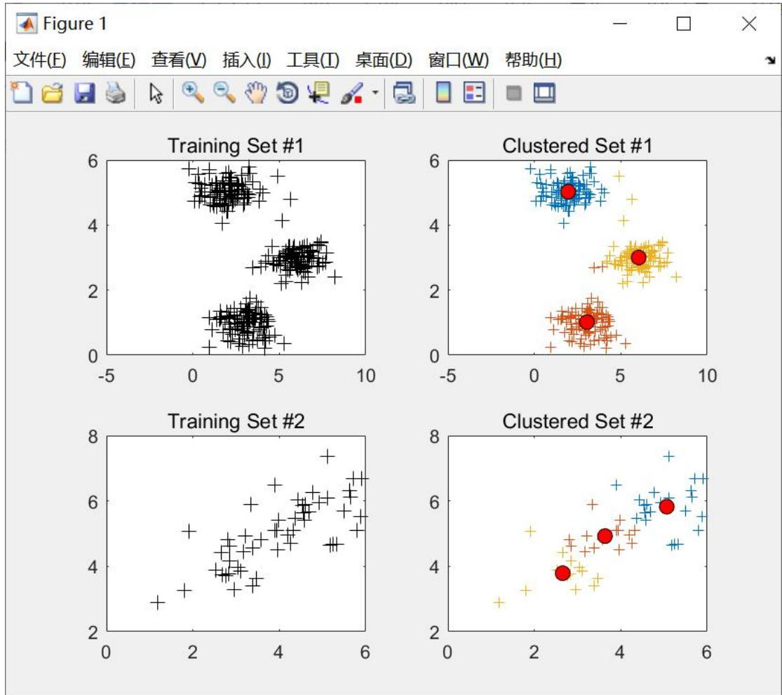
以训练数据集 2 为例，`centroids` 矩阵中保存着 3 个中心点的坐标，即分配给该中心点的数据点的均值，`closest_centroids_ids` 矩阵中保存着与各个数据最接近的中心点的序号。
